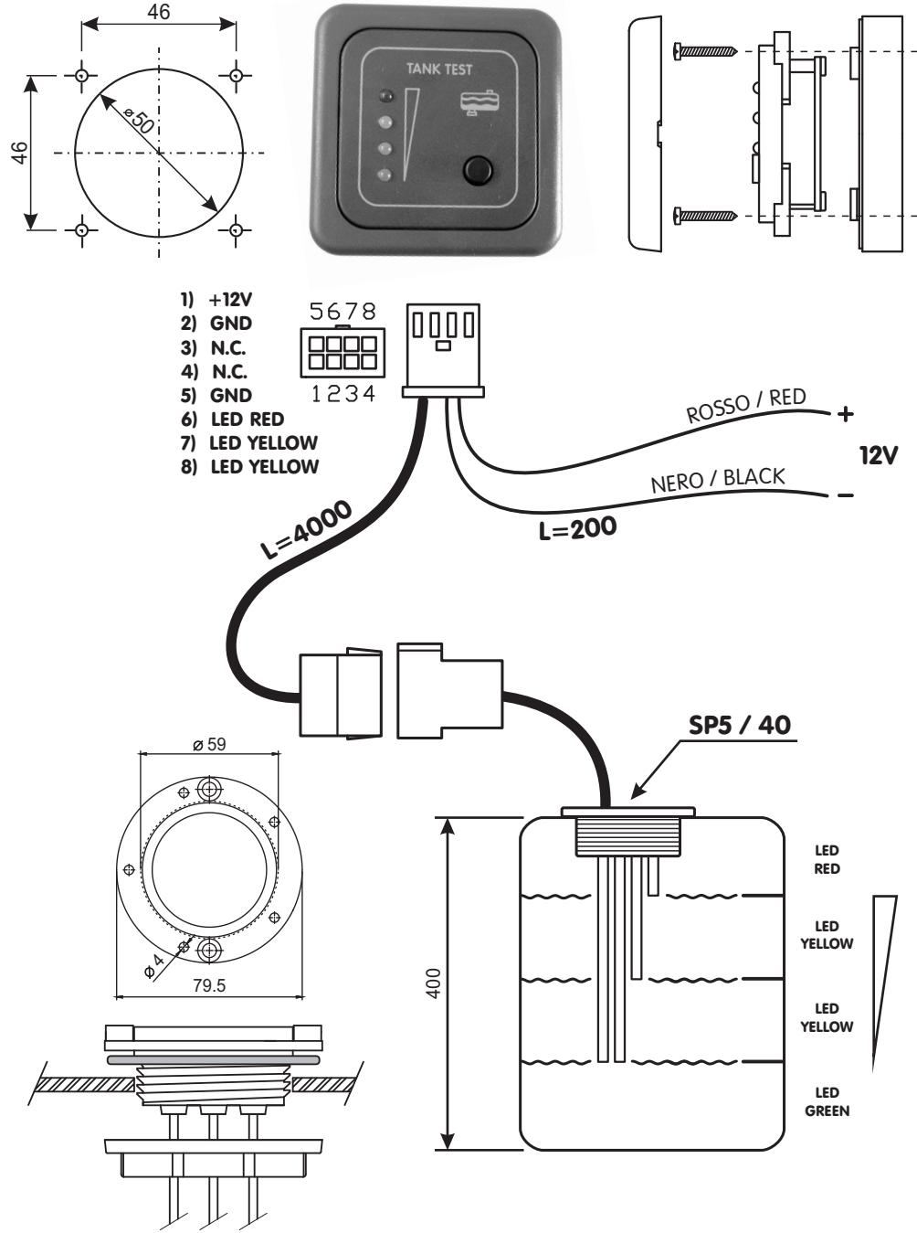
**I** **MTTR** - Pannello test a 12V per il controllo del livello di un serbatoio dell'acqua recupero. Collegare il pannello alla sonda recupero "SP5/..." e all'alimentazione tramite l'apposito cavo rispettando le polarità come in figura.
